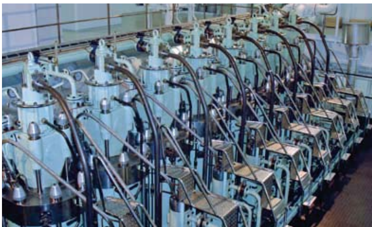
Achtzylinder-Zweitaktmotor (Bohrung 500, Hub 1910 mm) von MAN B&W aus dem Jahr 2004, mit einer Leistung von 12640 kW, bei einer Drehzahl von 127 min -1 , mit mechanischer Einspritzung des Kraftstoffs
