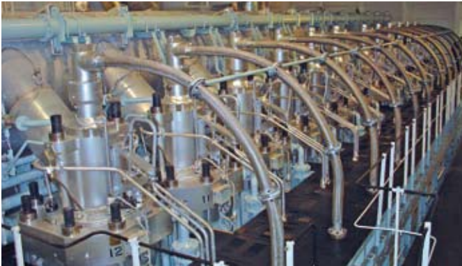
12-Zylinder-Zweitaktmotor (Bohrung 960, Hub 2500 mm) von Wärtsilä Sulzer von 2004. Dieser Zweitaktmotor kann eine Leistung von 61900 kW bei einer Drehzahl von 94 min -1 abgeben und ist mit einem Common Rail Einspritzsystem ausgerüstet
