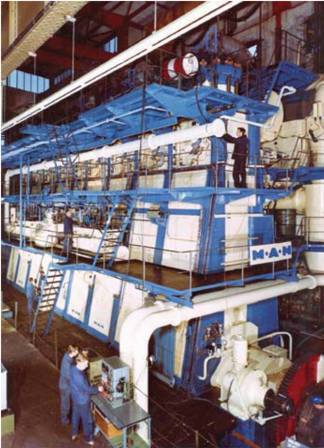
Vor dem Zusammenschluß der Maschinenfabrik Augsburg-Nürnberg und Burmeister & Wain auf dem Gebiet des Dieselmotorenbaus von 1980 (Fusion 1984), waren dies die größten Motoren beider Unternehmen, links ein MAN-Motor mit einer Bohrung von 1050 und einem Hub von 1900 mm, rechts ein 12-Zylinder-Motor von Burmeister & Wain, Bohrung 900 und Hub 2180 mm. Letzterer war 1980 mit 47300 PS der leistungsstärkste Dieselmotor der Welt. Sein spezifischer Kraftstoffverbrauch betrug 134,5 g/PS h . Die erste Serie von sechs Motoren war für Neubauten von A. P. Møller bestimmt
