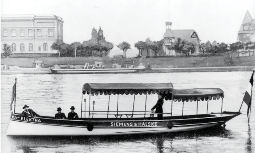
Erstes Motorboot mit elektrischem Antrieb, die »Elektra«, ausgerüstet von Siemens & Halske mit einem Motor von etwa 4,5 kW
